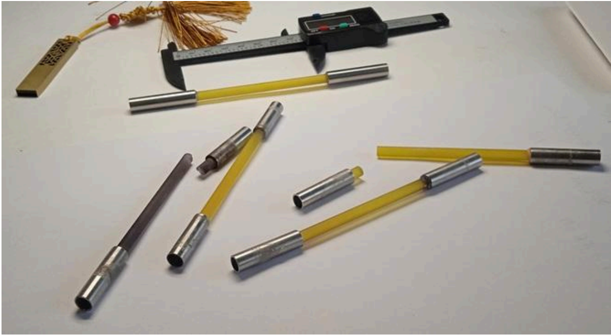
Кристалл для ND:YAG лазера по удалению татуировок, татуажа и перманента. Ремонт ручки неодимового лазера.
