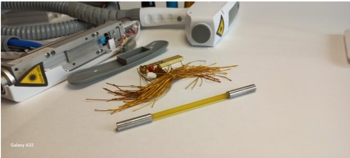
Кристалл для ND:YAG лазера по удалению татуировок, татуажа и перманента. Ремонт ручки неодимового лазера.
