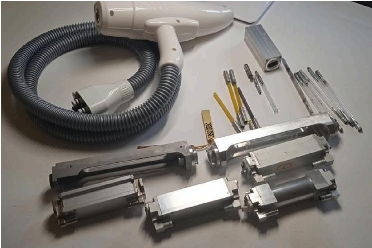
Пример разобранной ручки неодимового лазера для удаления татуировок, тату и карбонового пилинга.
